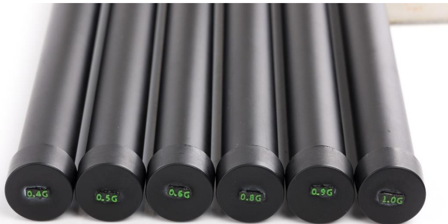
Рисунок 11.4. Маркування на антенах, що повинні відповідати маркуванню каналів, до яких під'єднуються антени.
