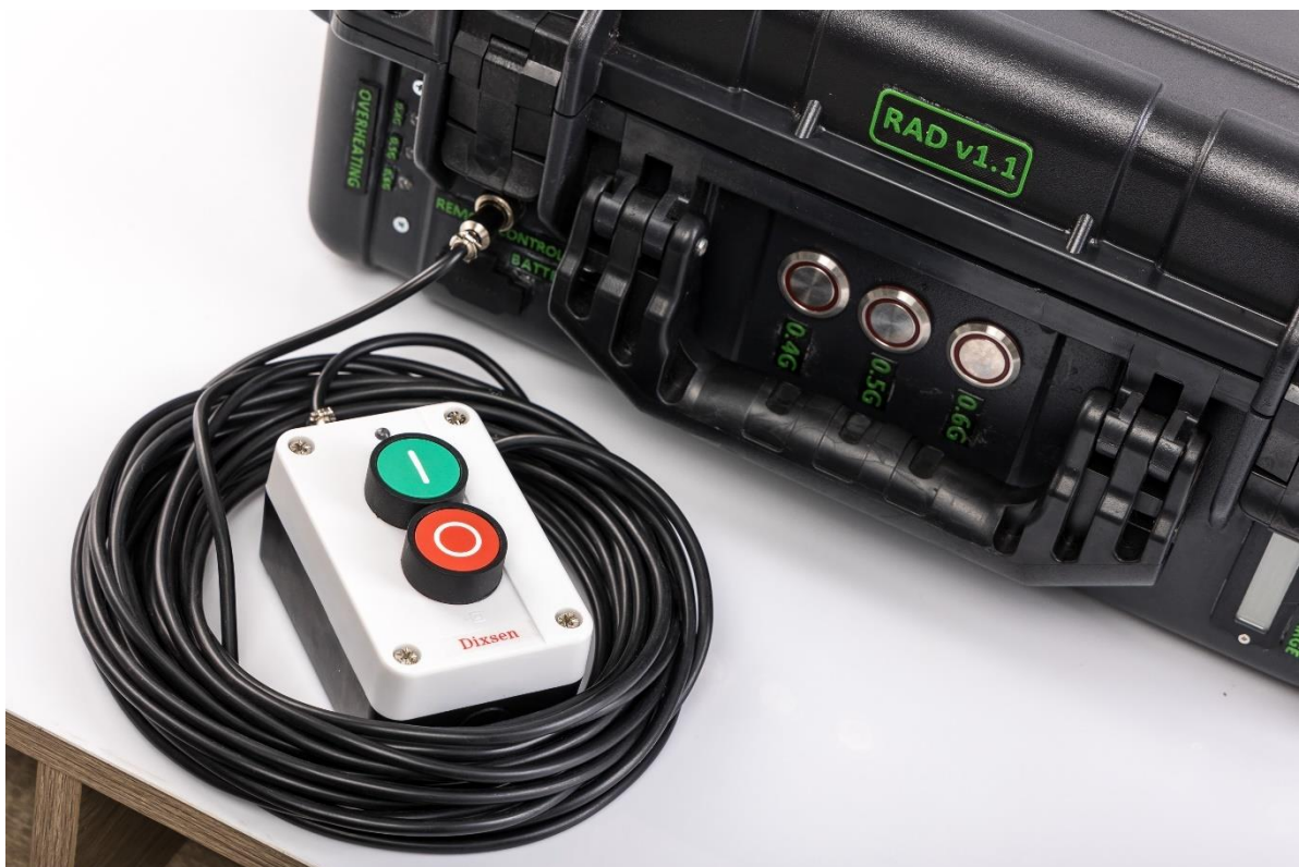
Рисунок 11.6. Підключений пульт для дистанційного увімкнення / вимкнення засобу РЕБ
