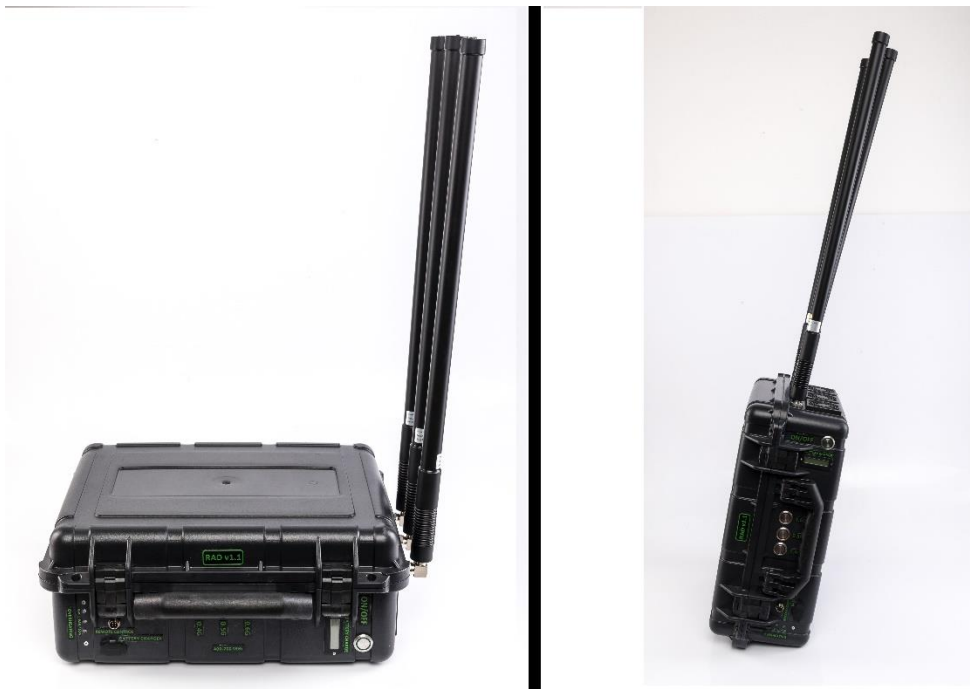
Рисунок 11.5. Засіб РЕБ з антенами, під'єднаними через прямокутні перехідники (зліва), та з безпосередньо під'єднаними вертикально антенами (зправа).
