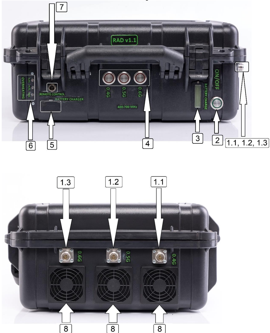
Рисунок 11.1. Елементи керування засобу РЕБ
