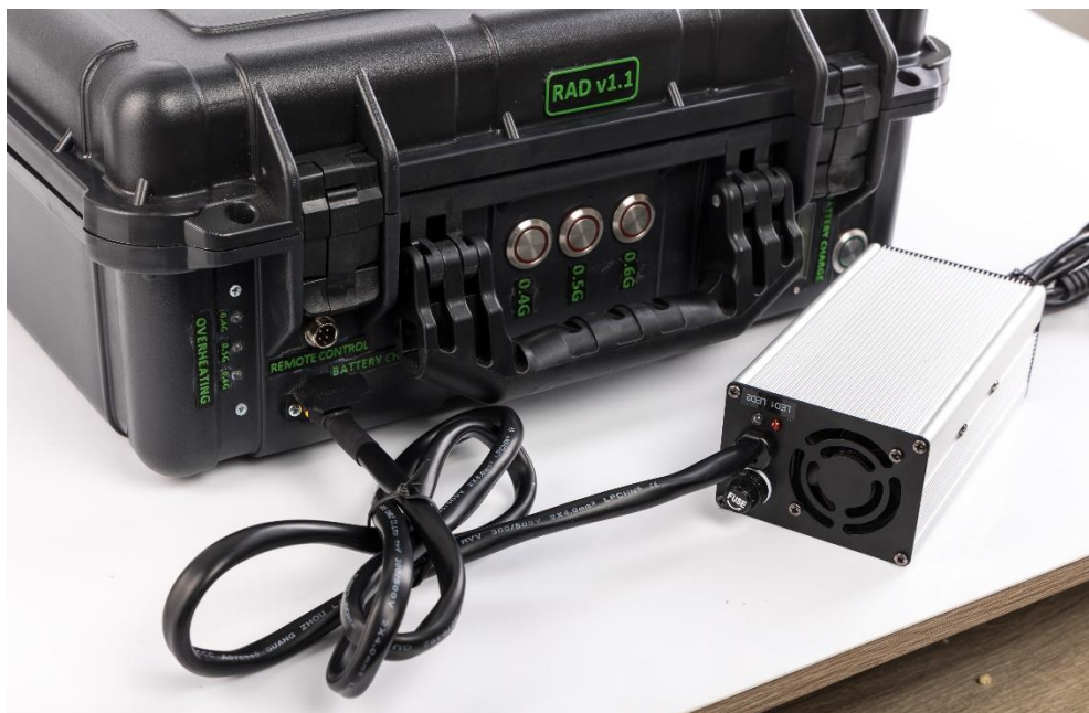
Рисунок 11.2. Зарядний пристрій приєднаний до засобу РЕБ.
