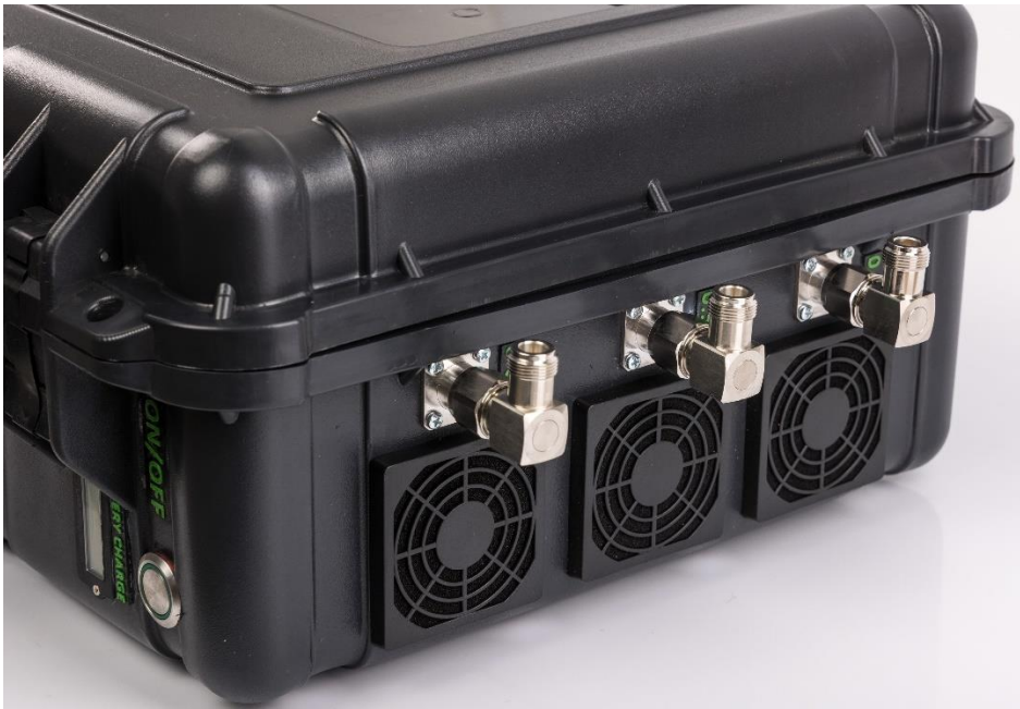
Рисунок 11.3. Перехідники, що підключені до роз'ємів засобу РЕБ, призначені для приєднання антен під прямим кутом до корпусу засобу.
